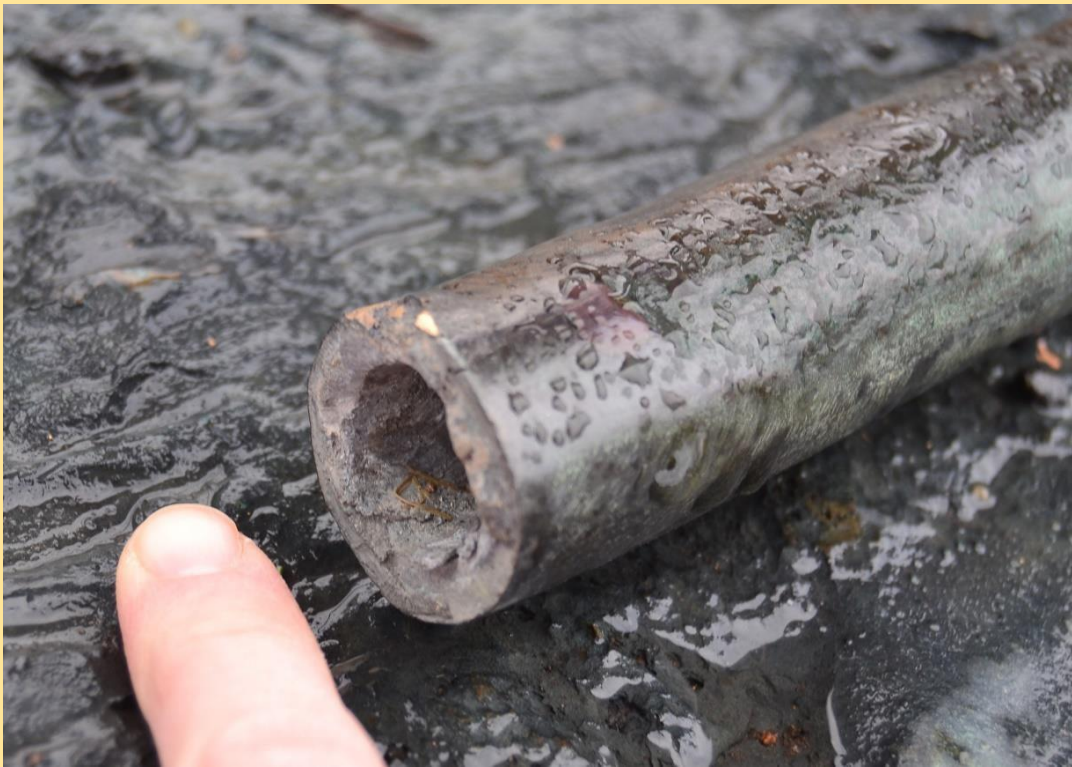
Aisan pohjoispuolen liitoskohta: Aisamateriaalin vahvuus noin 6 mm, vertailukohtana pikkusormen kynsi.
