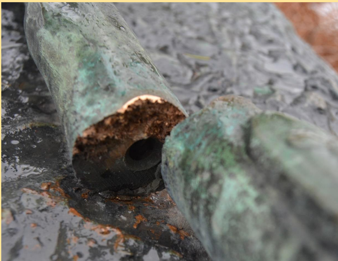
Viimeisin murtumakohta eteläpuolella lähinnä äestä: Pelkkä juotosliitos ja paksumpi pronssivalu.
