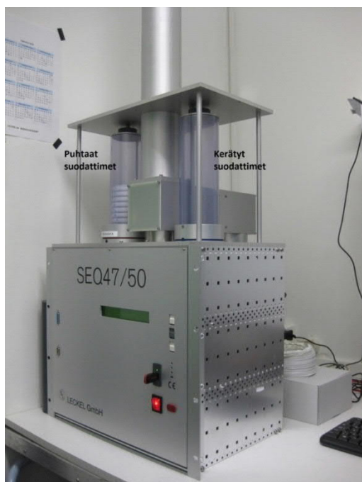
Kuva 4. Harjavallan Kalevan ja Pirkkalan mittausasemilla on Leckel SEQ 47/50 -hiukkaskeräimet PM 10 -metallinäytteiden keruuta varten. Laite kerää vuorokausinäytteen kerran viikossa. Näytteet kerätään satunnaisotannalla eri viikonpäivinä. Automaatio hoitaa suodattimien siirron keräyskammiosta analysoitavien suodattimien säiliöön. Suodattimet analysoidaan KVVY Tutkimus Oy:n laboratoriossa Tampereella standardin EN 14902:2006 mukaisesti.
