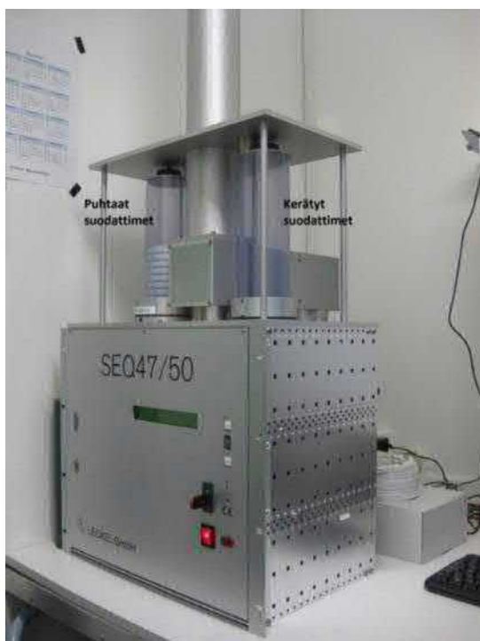
Kuva 4. Harjavallan Kalevan ja Pirkkalan mittausasemilla on standardin EN 12341:2014 vaatimukset täyttävät Leckel SEQ 47/50 -hiukkaskeräimet PM 10 -metallinäytteiden keruuta varten. Laite kerää vuorokausinäytteen kerran viikossa. Näytteet kerätään satunnaisotannalla eri viikonpäivinä. Automaatio hoitaa suodattimien siirron keräyskammiosta analysoitavien suodattimien säiliöön. Suodattimet analysoidaan KVVY Tutkimus Oy:n laboratorioissa Tampereella standardin EN 14902:2006 mukaisesti.
