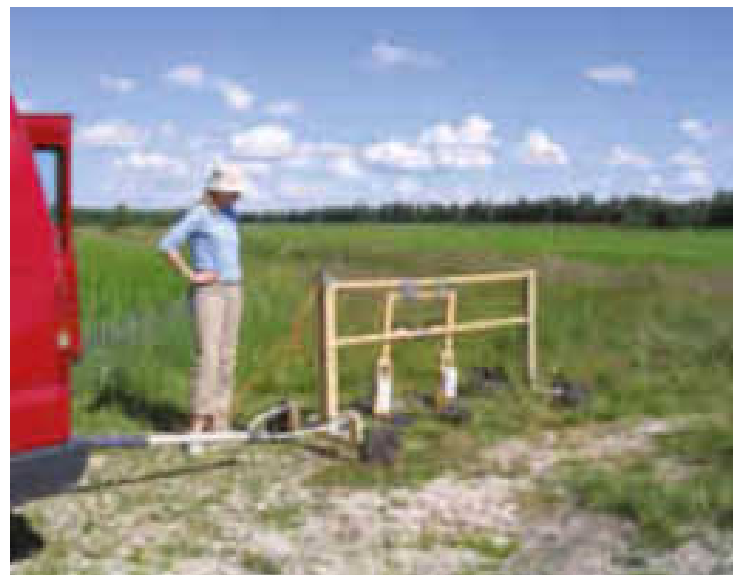
Kuva 13. Maatutkausta Säikän alueella. Kuva: Janita Peltonen
