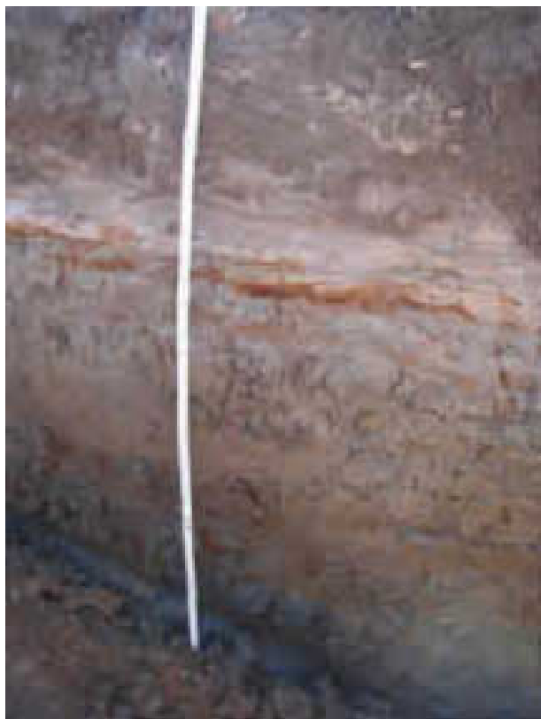
Kuva 29. Tutkimuskaivannon T5 (Hevosluoto) alaosassa Hevosluoto-muodostuman tummaa sulfidipitoista savista silttiä. Kuva: Catherine Cripps
