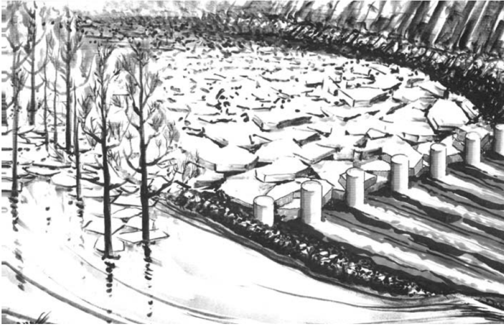
Kuva 5. Cazenovia Creekin jäänlähdon hallintarakenteen toimintaperiaate. Pilarit pitävät jääpadon paikallaan samalla kun vesi kiertää tulva-alueen kautta (Tuthil 2005).
