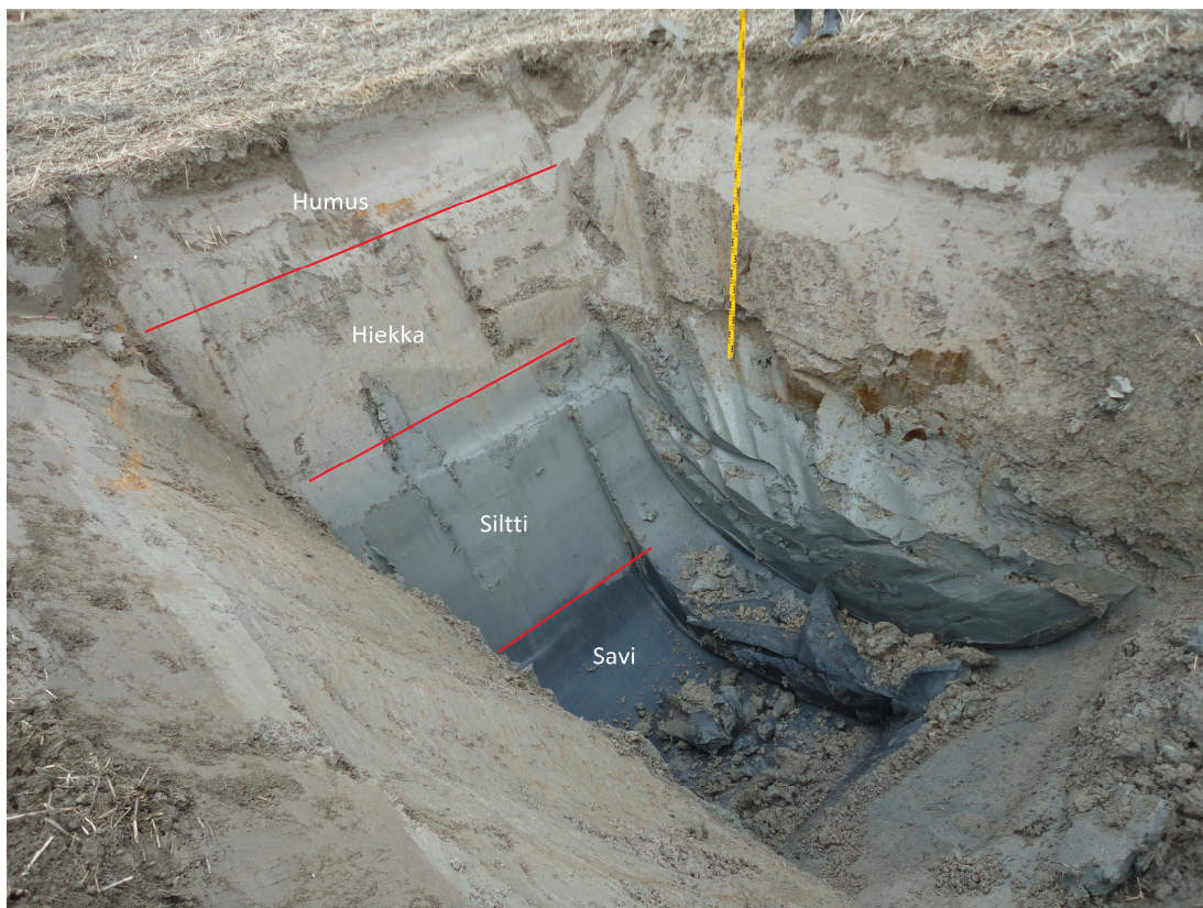
Kuva 5.6. Koekaivanto sisämaassa. (Heiskanen 2016)
