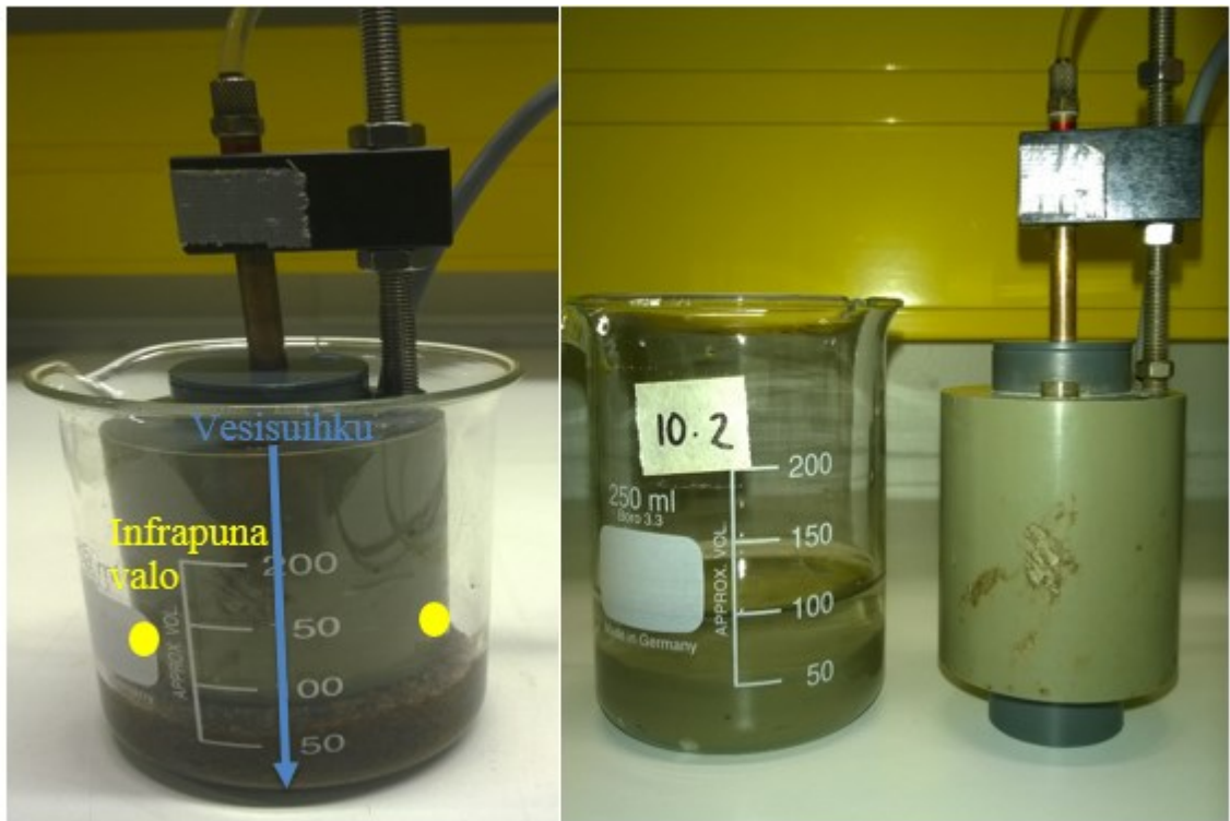
Kuva 22. Hiekka- ja savinäyte ja kriittisen leikkausjännityksen CSM -mittauslaite.
