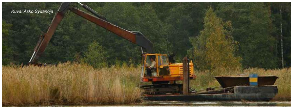
Kuva 13. Ruoppauskalusto. (Javanainen, K., Kemppainen, R., Orjala, M., Perkonjoja, M. & Saarni, K. 2013. Rytinää ruovikoihin – välkettä vesiin. Ohjeita ranta-alueiden hoitoon. Varsinais-Suomen ELY-keskus. Opas 3:2013. Jyväskylä: Kopijyvä Oy, 15.)
