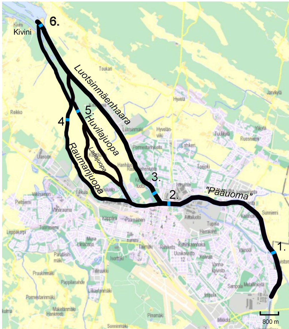
Kuva 7: Virtausmallin uomarakenne ja vedenkorkeuden mittauspisteet 1-6.
