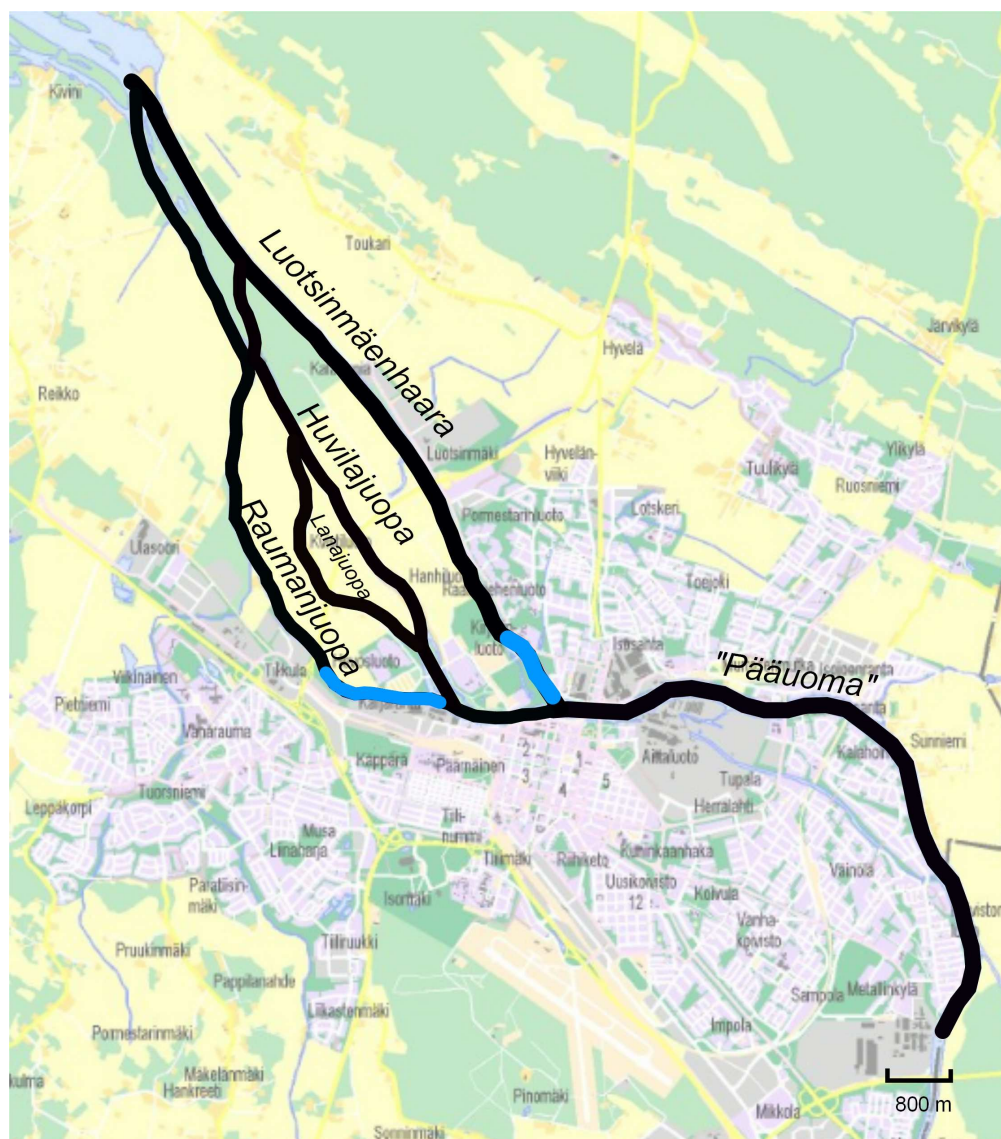
Kuva 9: Luotsinmäenhaaraan ja Raumanjuopaan kehittyneiden jääpatojen sijainti. Jääpadot on merkitty sinisellä.
