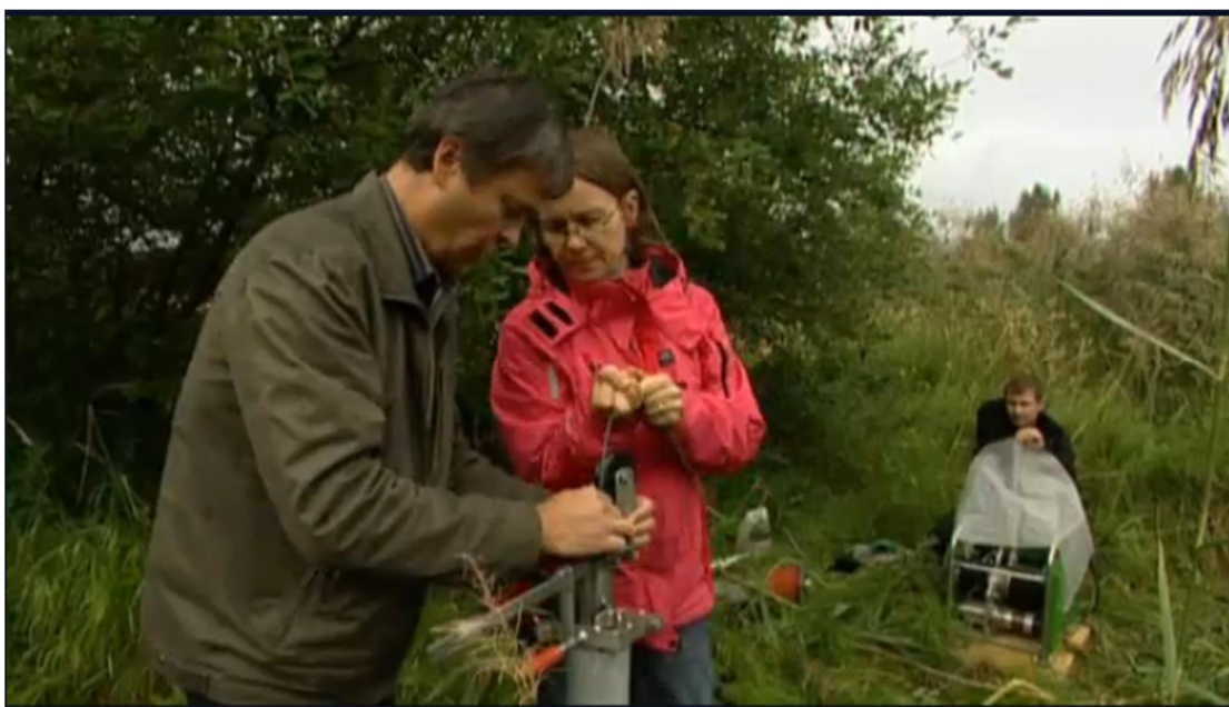
Kuva 13. Luonnollisen gammasäteilyn mittausta pohjavesiputkesta näytepisteellä 30_920 (Kuva Yle).
