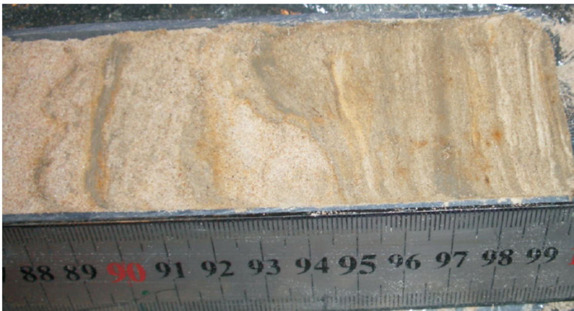
Kuva 22. Näytepisteellä 30_920 +0,90 – +0,78 metrin (N2000) syvyydellä näkyy Säikkä-muodostumalle tyypillistä siltin ja hienon hiekan vuoroittaisia kerroksia.
