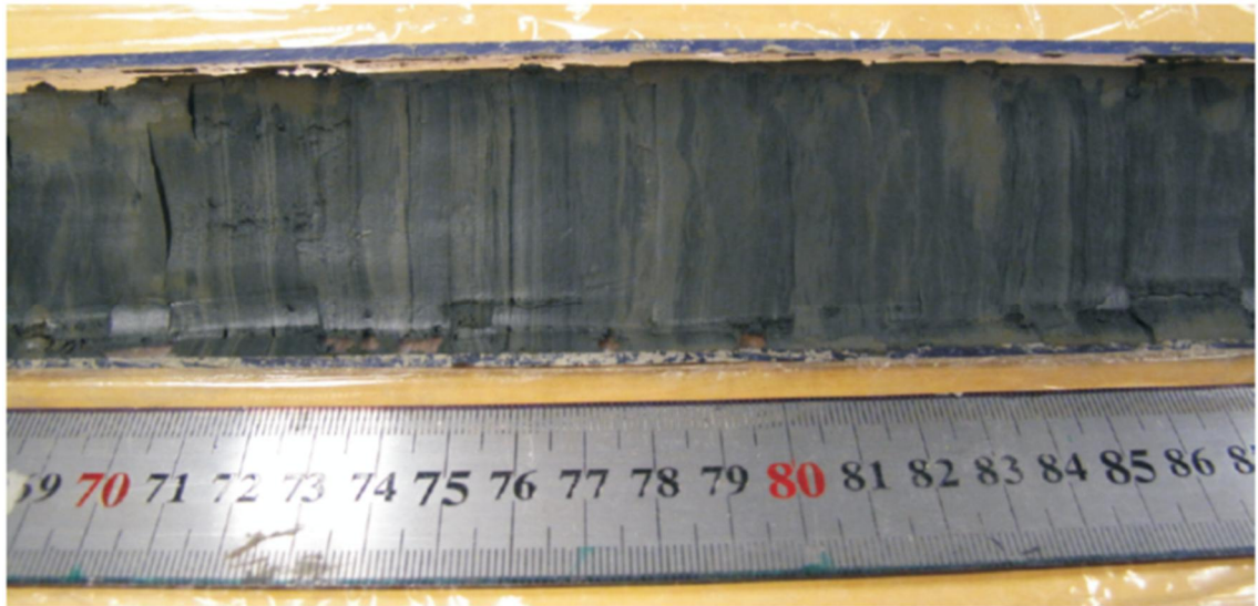
Kuva 20. Näytepisteellä 30_920 -3,91 – -4,08 metrin (N2000) syvyydeltä otetussa näytteessä näkyy Hevosluoto–muodostumalle tyypillistä tummaa sulfidipitoista laminaatiota.
