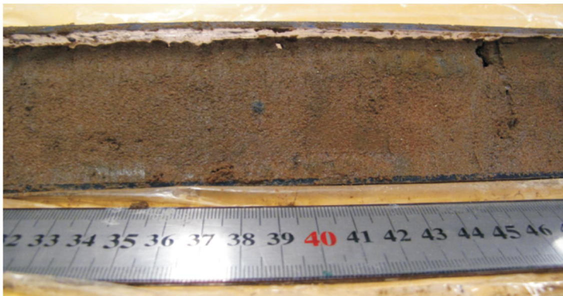
Kuva 21. Näytepisteellä 30_920 -2,54 – -1,68 metrin (N2000) syvyydeltä otetussa näytteessä näkyy Lanajuopa–muodostuman hienosta keskikarkeaan hiekkaan. Näyte on häiriintynyt näytteenotossa.
