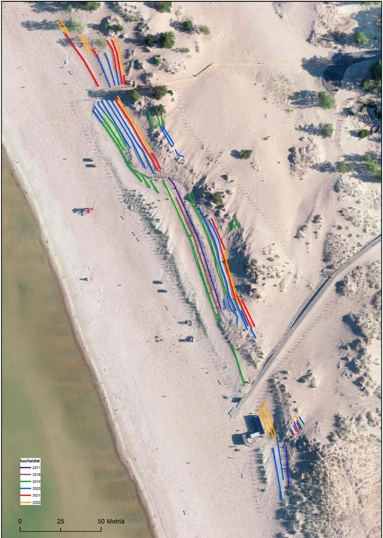
Kuva 20. Vuosina 2017–2022 asennetut tuuliaidat. Tuuliaitojen määrää on lisätty selvästi vuoden 2018 jälkeen.
