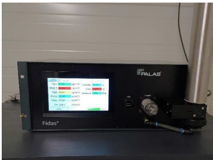
Kuva 3. Harjavallan Pirkkalan mittaus-asemalla otettiin 7.4.2022 käyttöön Fidas 200 -hiukkasanalysointilaitte, joka mittaa useampaa eri hiukkaskokoa, mm. hengitettäviä hiukkasia ( PM_{10} ) ja pienhiukkasia ( PM_{2.5} ). Nyt kolmella mittausasemalla on sama analysointilaitte, jolloin huollot sekä kalibroinnit helpottuvat.
