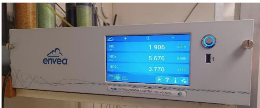
Kuva 3. Paanakedonkadun mittausaseman typenoksidien (NO x ) analysaattori uusittiin keväällä 2023. Rauman kaupunki hankki samanaikaisesti vastaavan laitteen Hallikadun mittausasemalle.
