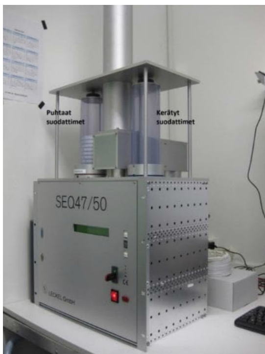
Kuva 6. Harjavallan Kalevan ja Pirkkalan mittausasemilla on standardin EN 12341:2014 vaatimukset täyttävät Leckel SEQ 47/50-hiukkaskeräimet PM_{10} -metallinäytteiden keruuta varten. Laitte kerää vuorokausinäytteen kerran viikossa. Näytteet kerätään satunnaisotannalla eri viikonpäivinä. Automaatio hoitaa suodattimien siirron keräyskammiosta analysoitavien suodattimien säiliöön. Suodattimet analysoidaan KVVY Tutkimus Oy:n laboratorioissa Tampereella standardin SFS-EN 14902:2006 mukaisesti.
