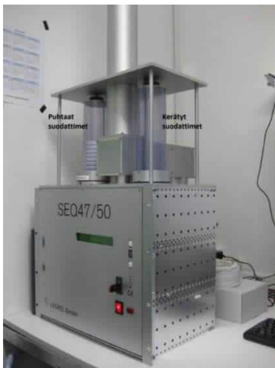
Kuva 4. Harjavallan Kalevan ja Pirkkalan mittausasemilla on standardin EN 12341:2014 vaatimukset täyttävät Leckel SEQ 47/50-hiukkaskeräimet PM_{10} -metallinäytteiden keruuta varten. Laite kerää vuorokausinäytteen siten, että keräyspäiviä tulee kalenterivuodessa 183 kpl/mittausasema. Suodattimet analysoidaan KVVY Tutkimus Oy:n laboratoriossa Tampereella standardin SFS-EN 14902:2006 mukaisesti.
